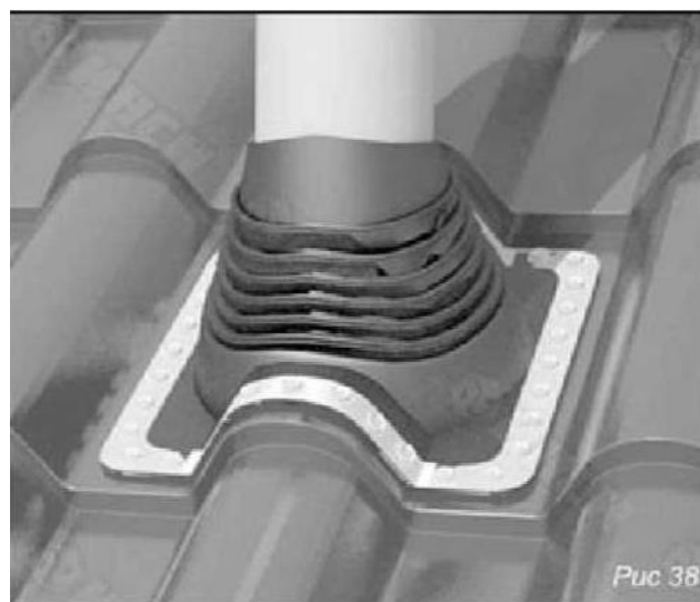
Рис. 19 Выход фановой трубы круглого сечения (фирма Völpre); диаметром до 330 мм (с температурой до 130°) с применением кровельных уплотнителей Master Flash
