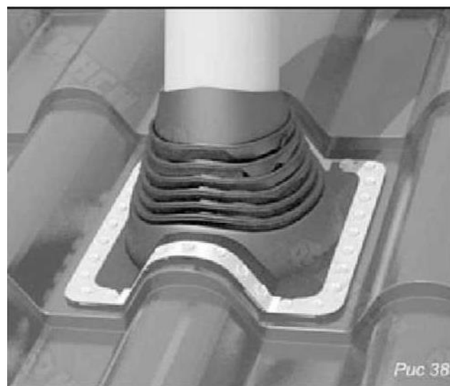
Рис. 19 Выход фановой трубы круглого сечения (фирма Vipe); диаметром до 330 мм (с температурой до 130°) с применением кровельных уплотнителей Master Flash
