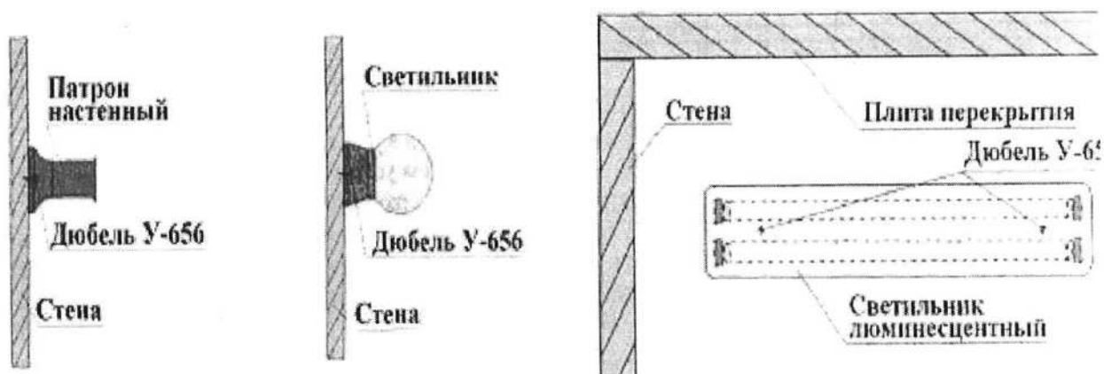
Рисунок 1. Установка светильников и настенных патронов на строительные основания
